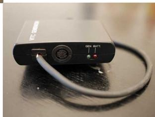
Diese winzige Gerät wurde ursprünglich für einen JVC Camcorder gebaut. Es ermöglicht die Einstellung von User Bits und produziert einen fortlaufenden Timecode
