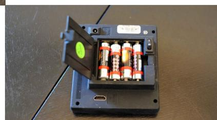
Dieser Marshall V-LCD50 HDMI Monitor mit Peaking Filter ist für die Bildkontrolle gedacht und kann mit normalen Batterien versorgt werden. Für manche Drehs ein großer Vorteil
